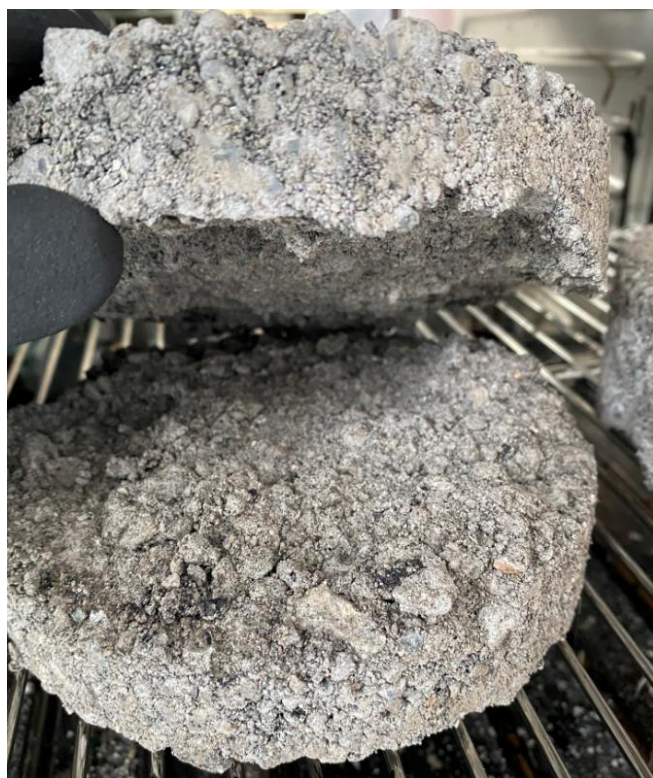
Figur 3.3.1: BSM-kernerne produceret og lagret ved 5 grader C havde så ringe kohæsion, at nogle af dem lagdelte allerede inden mekanisk prøvning.
