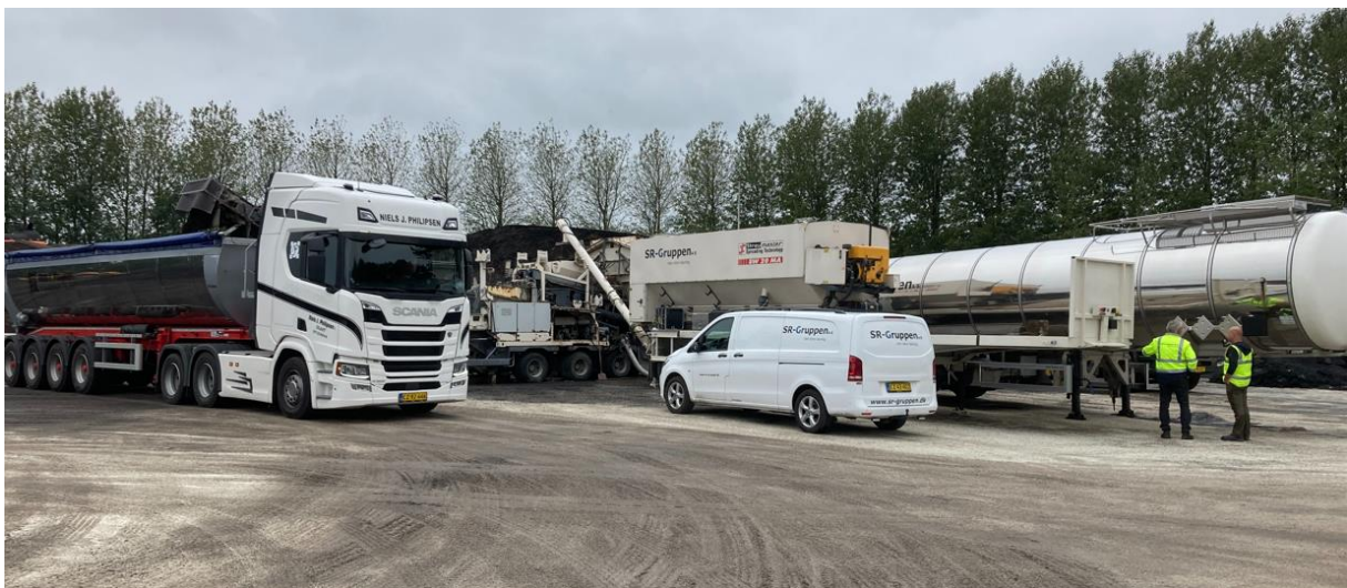
Fig. 4.1: Produktion af BSM på SR-Gruppens mobile KMA-anlæg.
