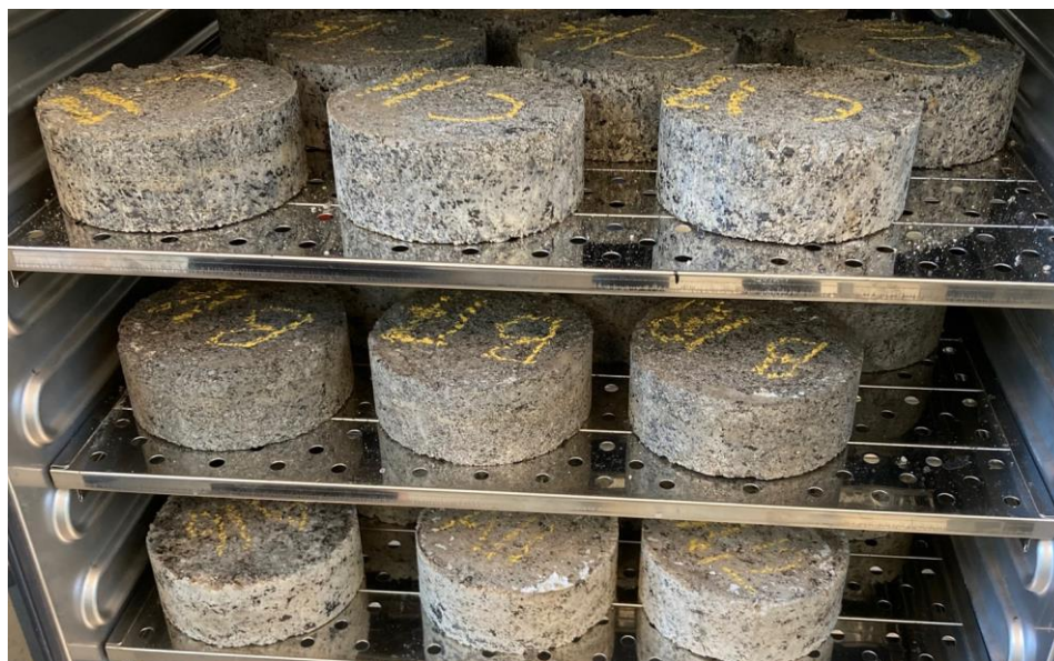
Fig. 8.1: For hver af de tre blanderecepter er der langtidslagret 9 stk. vibrationsindstampede kerner til test efter lagring i 8 uger. Bemærk også her, hvordan serie A (nederst, med 6% kalkfiller) er noget lysere end blanding C (øverst, WR-fræs med 20% stenmel) og meget lysere end blanding B (midterste hylde, genbrugsasfalt Gammelrand med 20% stenmel).
