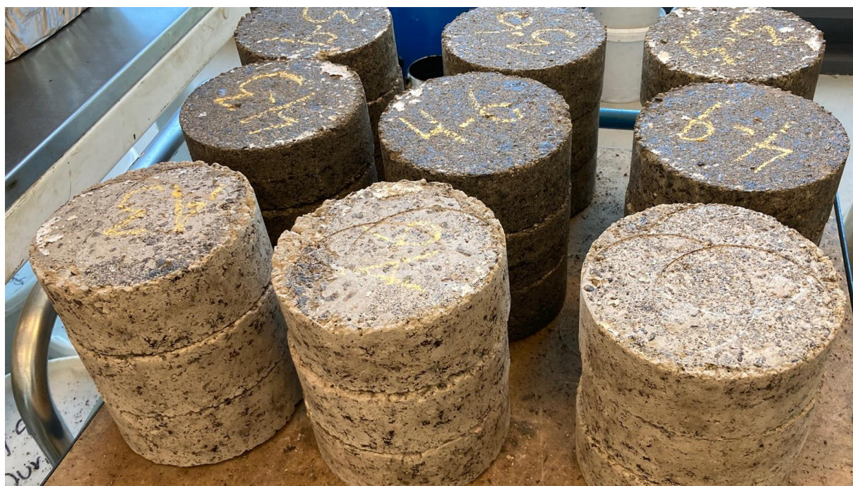
Fig. 7.1: BSM prøvelegemer før test. Bemærk, hvordan BSM-materialet (blanding a) med "standard" genbrugsasfalt fra Gammelrand, tilsat 6% kalkfiller (ses i forgrunden) fremtræder meget lysere end de bagved stående testserier af BSM fremstillet på normal vis med genbrugsasfalt uden ekstra fillertilsætning.
