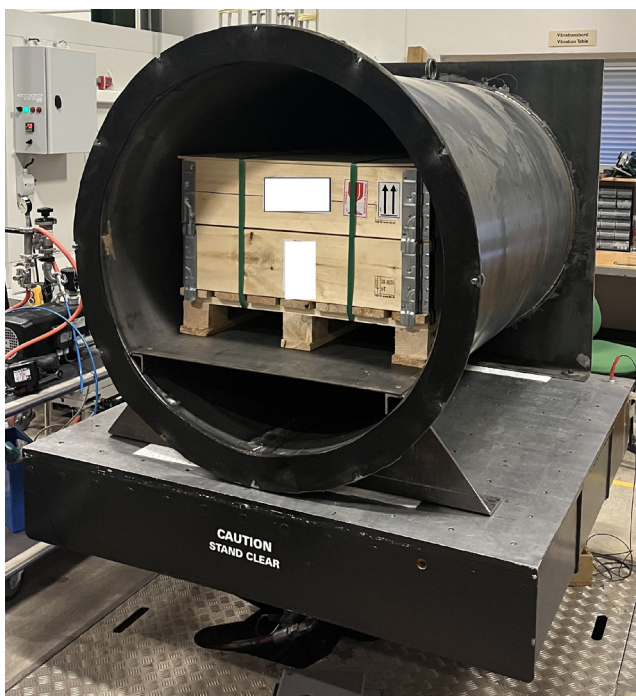
Vakuumkammer med europalle monteret på vibrationsbord før test
