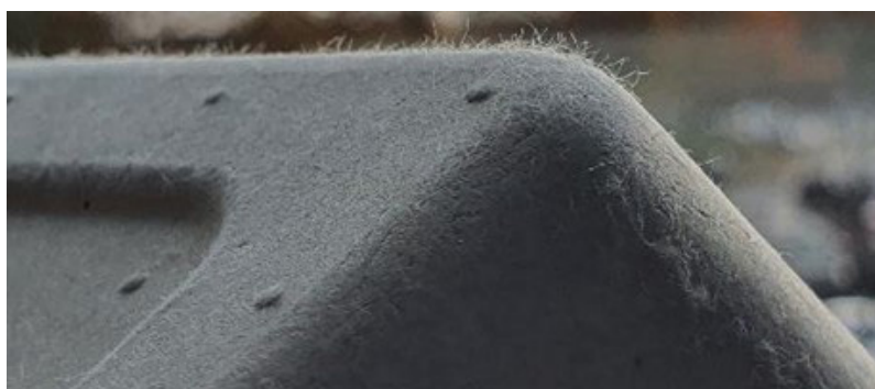
Figur 3: Fiberløft på en vådstøbt termoformet Kraft-pulp-fiberoverflade.
