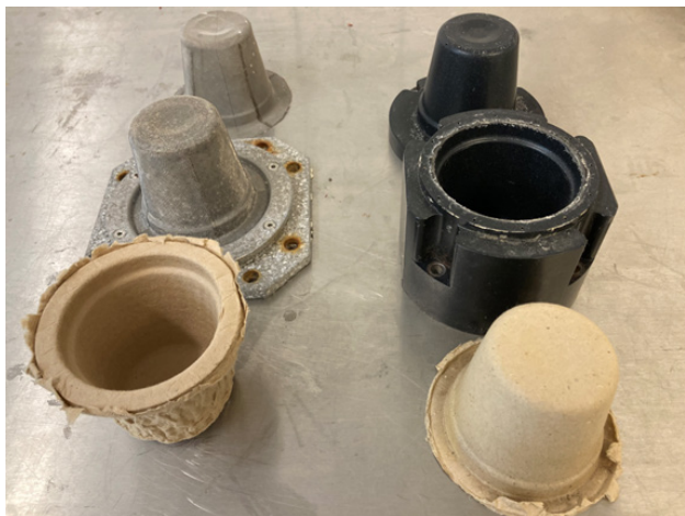
Figur 9: Værktøjssæt til støbning af bægre. På venstre side af billedet ses et bægerformet fiberopsamlingsnet, en fiberopsamlings- (vådstøbning) form og et vådformet lufttørret (ukomprimeret eller tykvægget) bæger; på højre side ses to varmepræseforme og et termoforment bæger.
