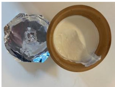
Figur 12: Resultater fra den kølede opbevaring af 18%-fedt creme fraiche i de udviklede bægre: gennemsnitlige vægtvariationer hen over opbevaringsperioden (venstre) og tilstanden af produktet på dag 31 af eksperimentet (højre).
