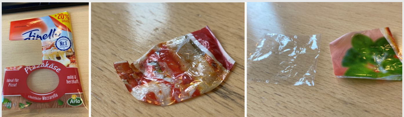
Figur 2. Emballagefilm til revet ost med PA- og PE-lag før og efter SEPARESCUE®-behandling. De gennemsigtige PA- og dekorerede PE-film blev fuldstændigt adskilt. PE-filmen kan nu deinkes, mens PA-filmen forbliver ren og klar til genanvendelse som den er.
