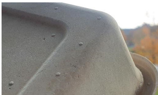
Figur 7: Vådstøbt termoformet Kraft-pulp (NBSK) indeholdende 5% tværbundet MFCP.
