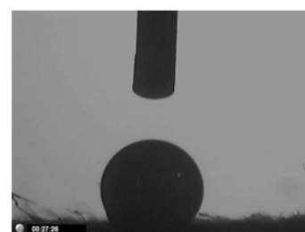
Figur 5: Interaktion af en dråbe REEF-2 coating med et termoformet NBSK fibersubstrat med tilsat AKD-størrelsebehandling. Dråben spreder sig ikke og holder formen, indtil belægningen tørrer ud.
