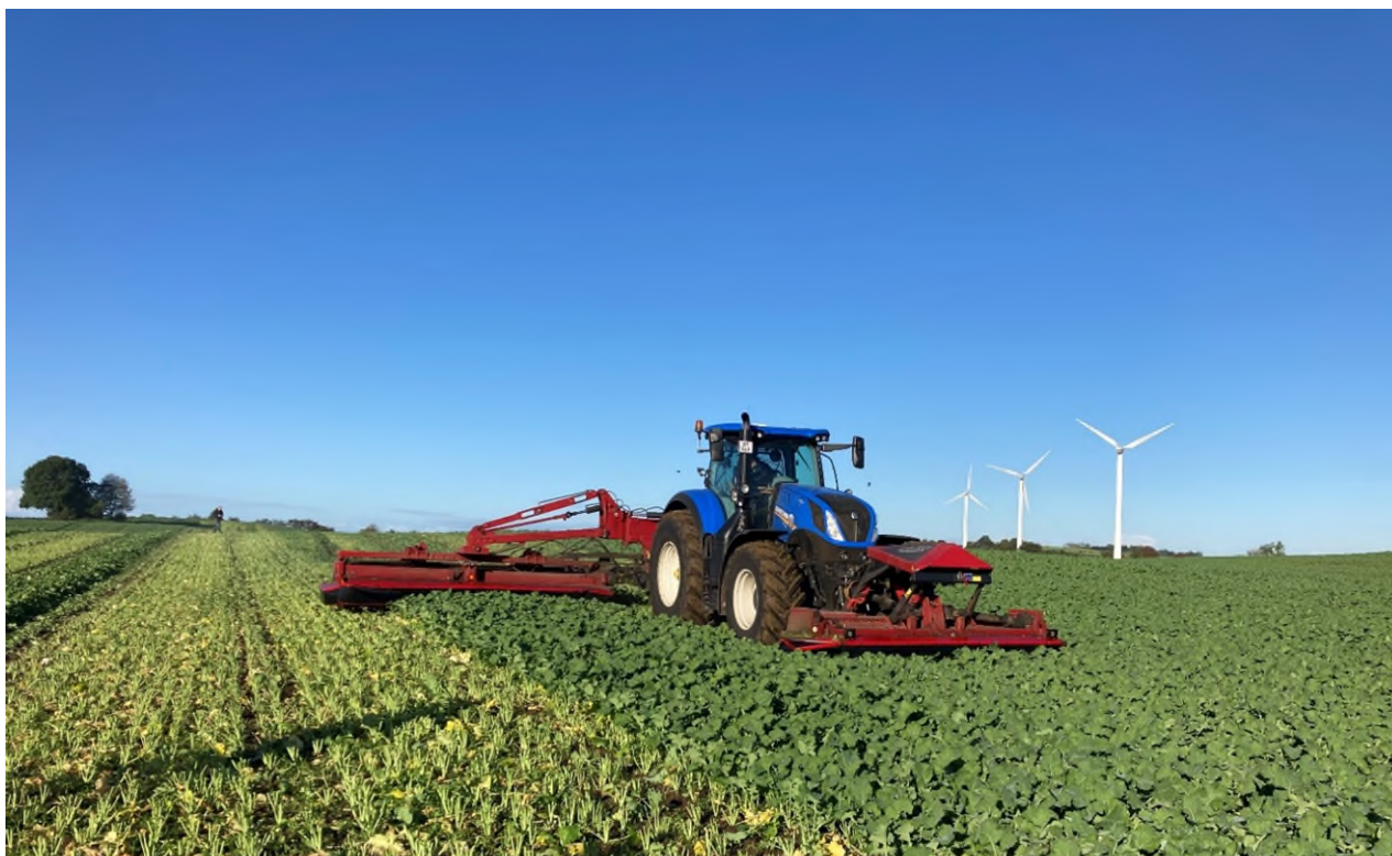
Figur 2. Skårlægning af rapblade med bugseret Kongskilde skårlægger, GXT 13005, 12,3 m Foto: Kurt Hjort-Gregersen, Teknologisk Institut
