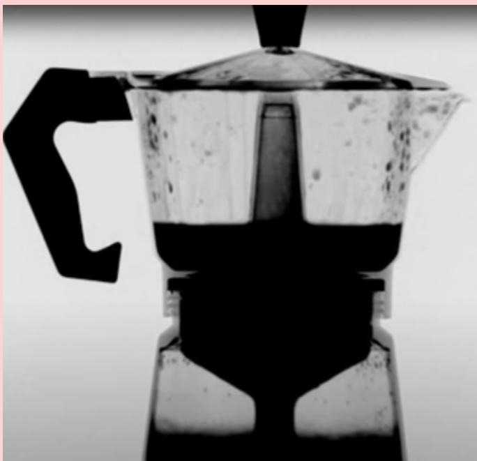
Brygning af Espresso i aluminiumskande når billedet er genereret med neutroner.
