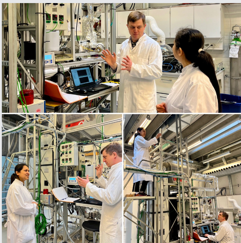
Laboratoriepilott på Teknologisk Institut hvor omdannelseshastigheden af cement med Oxyfuel-prosessen undersøges
