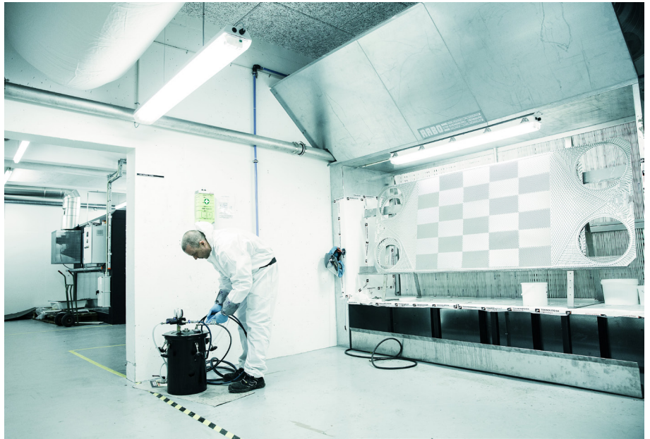
Figur 2: Pilot-produktionsanlægget muliggør coating af store og mange emner. Det inkluderer, foruden en stor sprøjtekabine og en hærdeovn, også faciliteter til udførelse af indgående og udgående kvalitetskontrol samt til opbevaring af emner før og efter coating.
