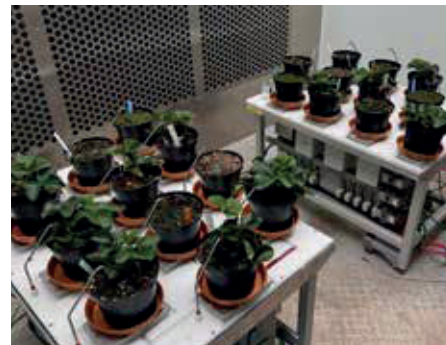
Klimakamre med mulighed for tærkeregistrering for den enkelte plante anvendes til forsøg med optimering af vandingsstrategi for de nye blandinger.
