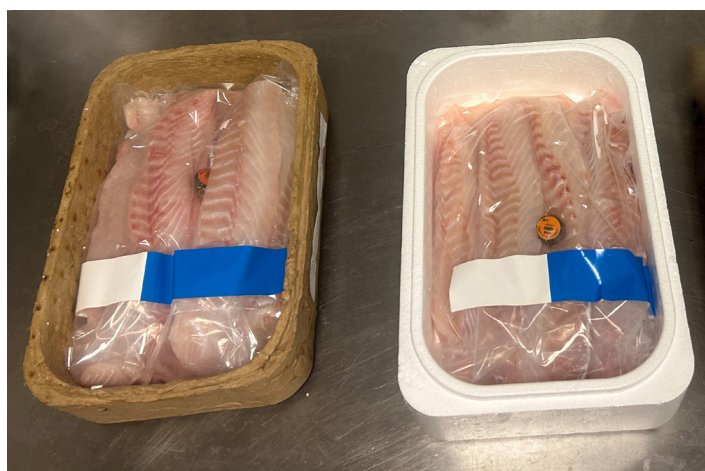
Flamingokasse og prototype af græsfiberformet kasse fremstillet hos Plast og Emballage, anvendt af Coolity og deres islandske fiskeriselskab-investor under det allerførste reelle fisketransportforsøg i september 2024.
