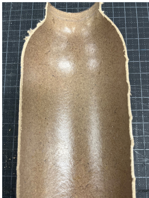
Figur 3. Indersiden af en fiberflaske belagt med en vandbaseret barrierecoating efter tørring ved hjælp af den patenterede ultralydsteknologi.
