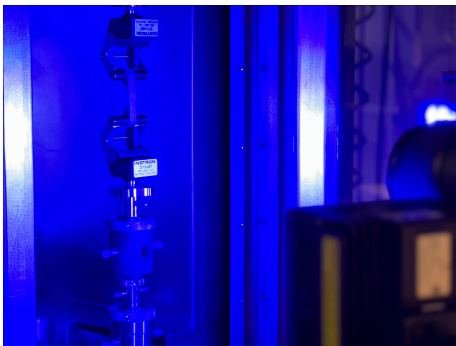
Testopsætning Plastlaboratoriets trækprøveudstyr med DIC-kameraudstyr til avanceret analyse af materialeegenskaber. Med indkøb af nyt udstyr til udmattelsestest tilføjes endnu mere indsigt i materialernes langtidsegenskaber.
