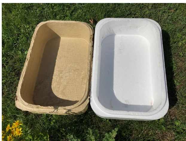
Flamingokasse og prototype af græsfiberformet kasse fremstillet hos Plast og Emballage, anvendt af Coolity og deres islandske fiskeriselskab-investor under det allerførste reelle fisketransportforsøg i september 2024.
